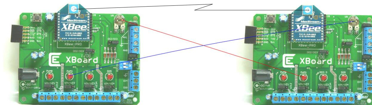
Ambos módulos están transmitiendo la medición del preset, el termistor, y el estado de los dip-switches. Los datos que ingresen por el pin TD serán transmitidos a la placa remota, saliendo por RD (y viceversa), junto con la información de las mediciones.
