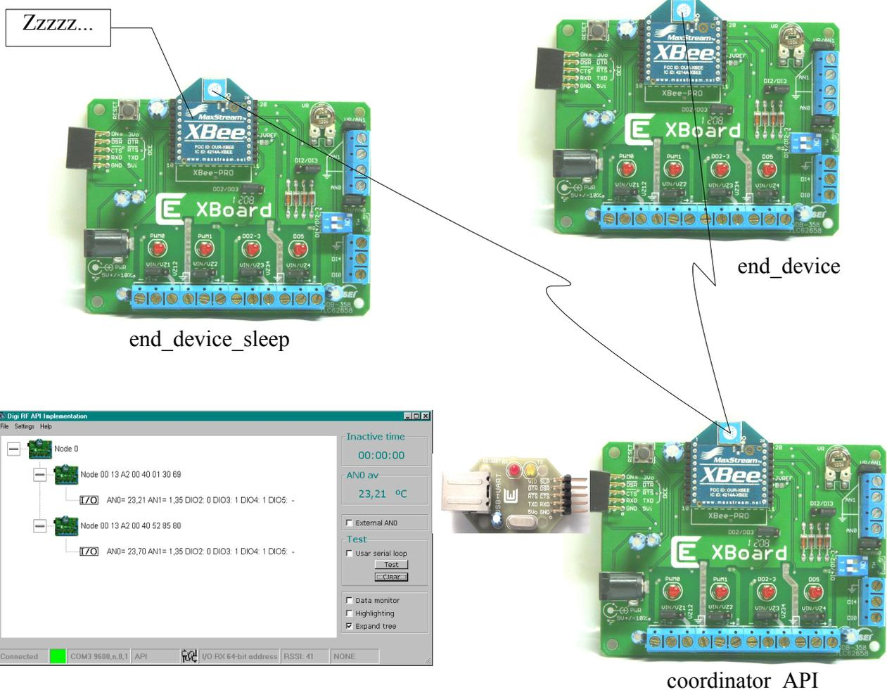
Observará que el LED PWM0 del coordinador enciende indicando la intensidad de la señal recibida. Si varía la posición del preset de la placa remota "end\_device", observará como cambia el valor indicado; la transmisión de información de ésta es a unas cuatro veces por segundo.
