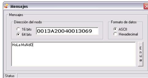
Colocando un loop en TD y RD (uniendo dichos pines en el conector con dos pines y un jumper o un trozo de alambre) en dicha placa, la información será devuelta al coordinador y la veremos en pantalla al despertar el módulo:
