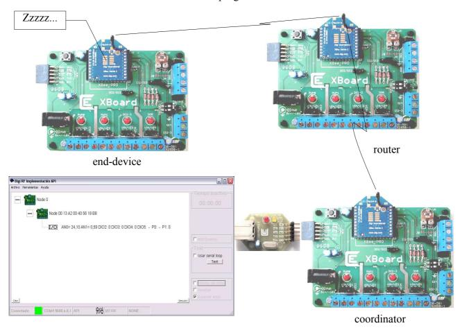
Observará que el LED PWM0 del coordinador enciende periódicamente indicando la intensidad de la señal recibida. La información es enviada por el end-device hacia el router, y de éste al coordinador<sup>5</sup>. Si varía la posición del preset de la placa remota conteniendo al end-device, observará como al despertar el módulo cambia el valor indicado. El módulo está configurado para dormir
