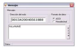
Colocando un loop en TD y RD (uniendo dichos pines en el conector con dos pines y un jumper o un trozo de alambre) en dicha placa, la información será devuelta al coordinador y la veremos en pantalla al despertar el módulo:
