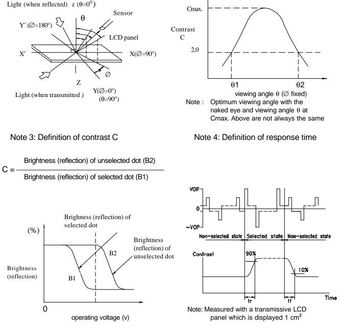
$V_{\text{OPR}}$  : Operating voltage  $t_r$  : Response time (rise)
