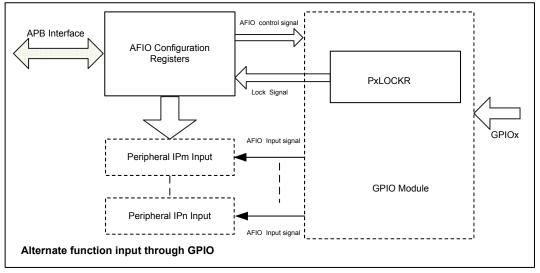
Figure 20. AFIO Block Diagram
