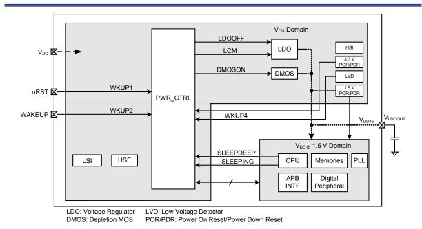
Figure 11. PWRCU Block Diagram
