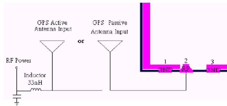
Deberá tenerse en cuenta que un corto en la antena producirá la circulación de una corriente relativamente elevada (dependiendo de la fuente que provea la alimentación), por lo que si es necesario detectar esta condición o soportarla, se deberá incluir el circuito pertinente antes del inductor.
