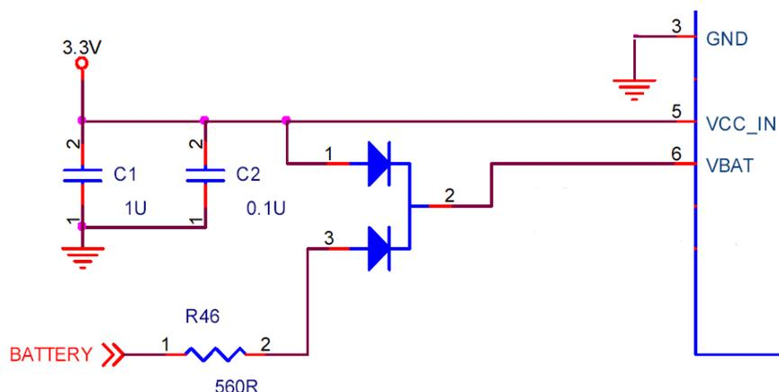
Los dos diodos se recomienda que sean Schottky, aunque según el fabricante el pin VBAT cumple su función con una tensión entre 2 y 3,5V.<sup>2</sup> A tal fin, recomendamos el BAT54C<sup>3</sup> que es un doble diodo Schottky con cátodo común.
