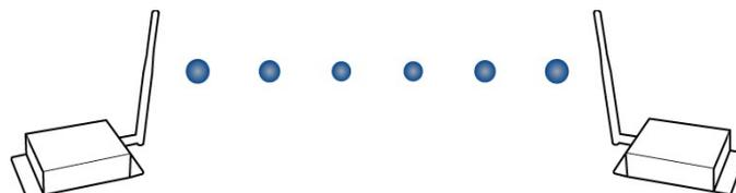
Por defecto, el XBee Wi-Fi funciona en modo transparente. En este modo, el módulo envía al remoto configurado como destinatario los mensajes que recibe por su puerto serie, y presenta en éste los mensajes que recibe del módulo remoto. Deberemos configurar las direcciones utilizando el comando *ATMY*<dirección> para la dirección propia y *ATDL*<dirección> para la dirección del remoto. Esto lo haremos en ambos módulos, por ejemplo:
