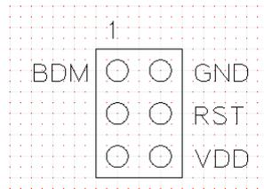
En la placa XBoard existe un conector de este tipo. Para adecuar una placa XBoard más antigua a un XBee Programmable, podemos conectarnos en los siguientes puntos:
