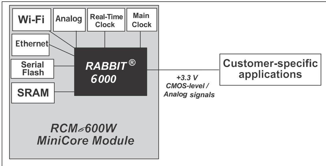
**Figure 8. RCM6600W Subsystems**
